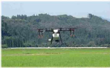
ドローンによる農業散布
